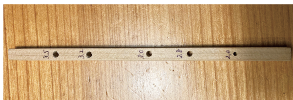
図11 檜材に5段階の孔を開け強度を比較
