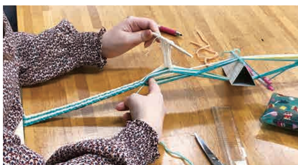
図13 輪状綜統による開口装置。
