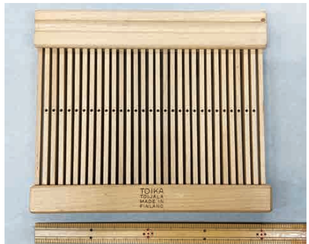
図4 市販の開口板綜統（TOIKA社, finland）：H180×W209×D18mm, 経密度：3本/cm, 板幅4.0mm, 孔径2.5mm, 隙間3.0mm
