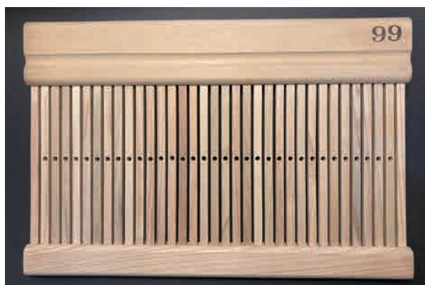
図12 3号機(製作 富田ウッドワーカー)2018年：H197×W295×D18mm, 経密度2.5本/cm, 板幅6.0mm, 孔径3.5mm, 隙間2.0mm
