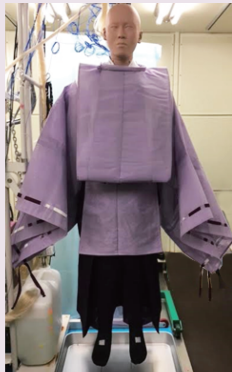
サーマルマネキンによる狩衣と差袴の熱抵抗計測の様子
